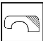
Limpar adequadamente a superfície a ser pintada, removendo partes soltas, ferrugem, oleosidades e resíduos impregnantes, com Solução Desoleante 400. Aplicar o Wash Primer 045 para proteger as áreas expostas onde a chapa foi atingida.
