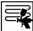
Aplicar 2 a 3 passadas com intervalo de 5 a 10 min entre passadas.
